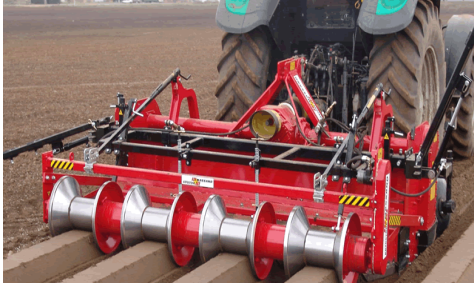
სურ. 1. სფერული კვლების წარმომქმნელი ტექნოლოგიური მანქანა
