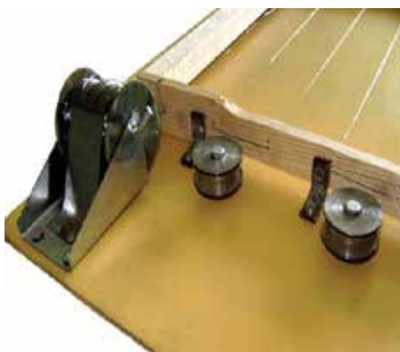
დაზგა ჩარჩოში მავთულის გასაჭიმად: 2- მბრუნავი კოჭი, 3-5 მავთულის კოჭას ნაწილები, 6-ფიქსატორები
