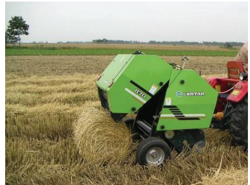
სურ. 17 მრგვალი ბარდანების დამამზადებელი მცირეგაბარიტიანი აგრეგატი
