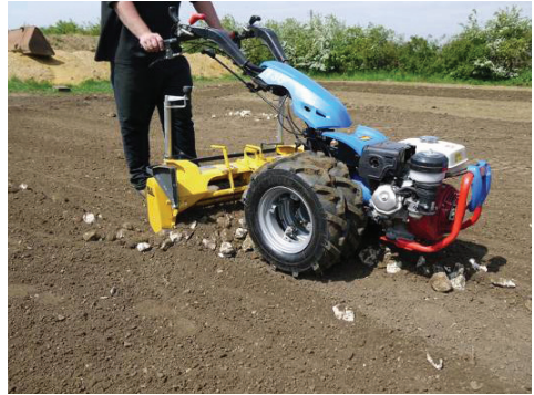
სურ. 5 ზედაპირული ქვებისგან ნიადაგის გამწმენდი მოტობლოკური აგრეგატი
