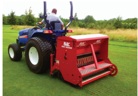
სურ. 10. მცირეკონტურიანი ნაკვეთებში ბალახების სათესი კომბინირებული მანქანა
