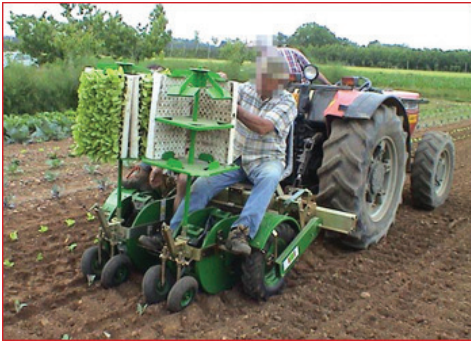
სურ. 11. მცირეკონტურნიანი ნაკვეთებისთვის განკუთვნილი ჩითილსარგავი კომბინირებული მანქანა
