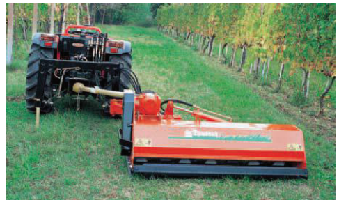
სურ. 13. მცენარეთა რიგთაშორისების დამცავი ზოლის დამამუშავებელი ფრეზი
