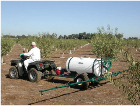
სურ.14 პალმეტური ზაღებისთვის განკუთვნილი მინიტრაქტორზე დააგრეგატებული შემასხურებელი მანქანა
