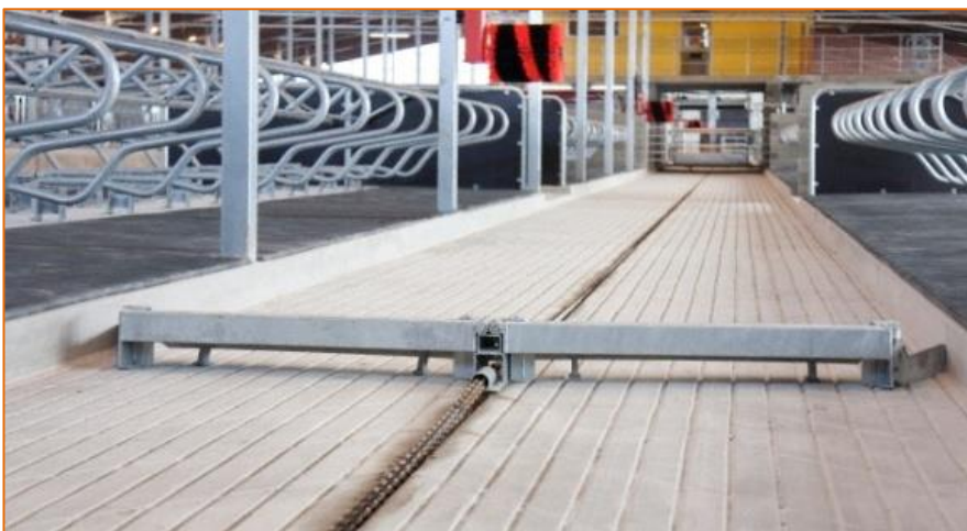
სურ. 25. ნაკელგამტანი ტრანსპორტიორის არხი, ცხოველი მას იყენებს საკვებურისა და საწყურვებლისკენ (და პირუკუ) გადასადგილებლად.
