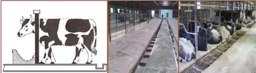
სურ. 24. დაბმულად შენახვისას ხვეტია ტრანსპორტიორით ნაკელგამტანის მოწყობის მოდელი
